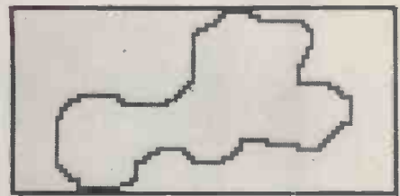
(d) Cell perimeter found using an edge-growing technique.
